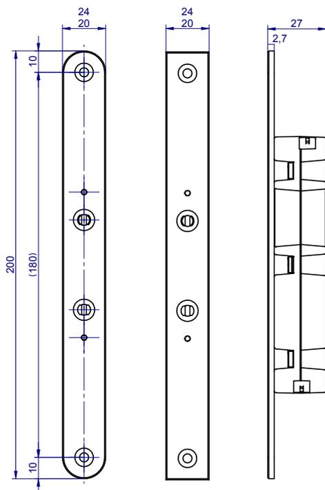
Dimensioni di fresatura +0,5 mm
