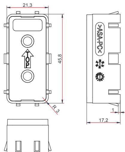
Dimensioni di fresatura +0,5 mm
